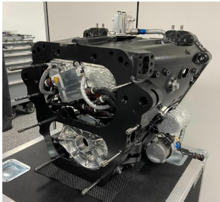
El nuevo ERS híbrido de INDYCAR se combinará con el motor V6 biturbo de 2.2 litros existente y producirá hasta 60 CV adicionales. La unidad híbrida estará situada en la zona de la campana del vehículo, entre el motor y la transmisión, lo que le permitirá adaptarse al chasis y al motor existentes.
